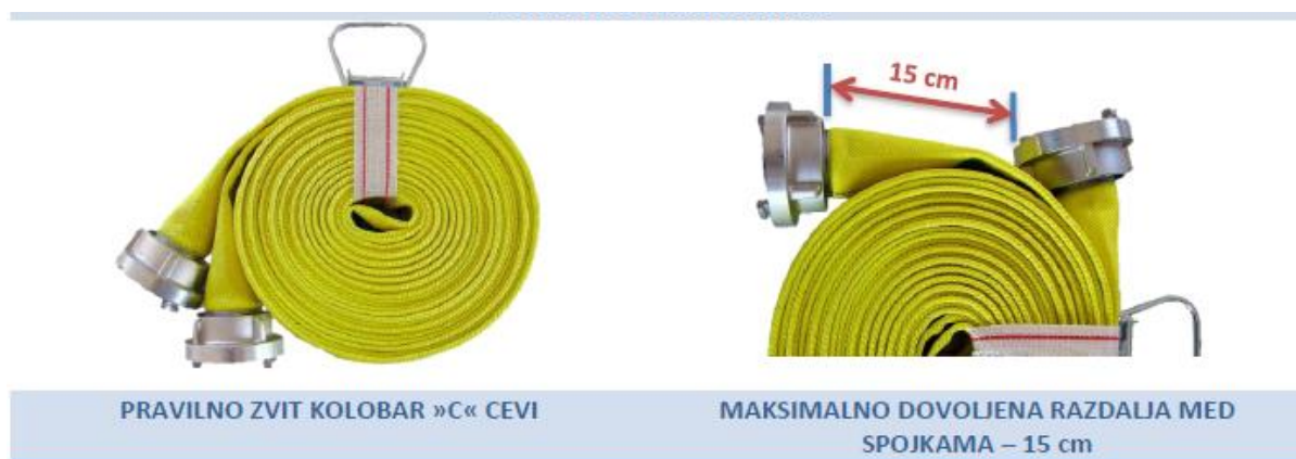
Slika 9: Pravilno zvita C-cev in maksimalno dovoljena razdalja med spojka (15 cm).
