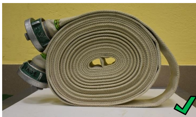
Slika 13: Pravilno zvita C-cev z dovoljeno ohlapnostjo.
